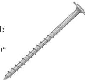
\* Die Länge der Schraube richtet sich nach dem Dachaufbau. Messen Sie vor der Schraubenauswahl die Höhe des Dachaufbaus, damit die Schraube mindestens 40 mm in den Sparren eingeschraubt wird.
