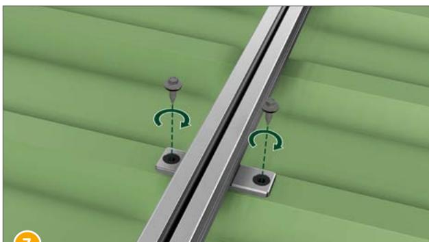
7 ... befestigen Sie das Trapez 6 mit je zwei Bohrschrauben 6 x 25 (Art.-Nr. 93160-25) und mit korrektem Drehmoment, ausgehend vom Trapez 4-2.0 nach außen.
