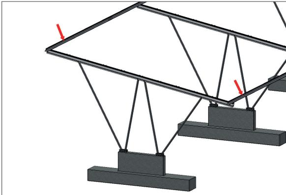
9. Je ein Modultragprofile (Pfette) am unteren und oberen Binder auflegen, in die vormontierten Klemmplatten einhängen, maßlich ausrichten und mittels Wasserwaage die Horizontale überprüfen.
