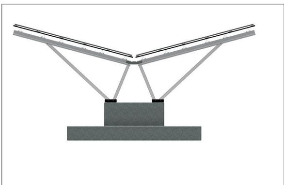
8. Beim sogenannten Schmetterlingscarport (C2Y) sind die Rohre (Streben) entweder mit einer digitalen Wasserwaage einzurichten oder die Höhen und Abstände mittels Maßband entsprechend zu vermessen
