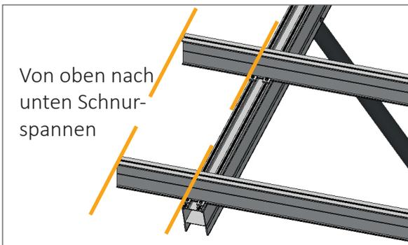
11. Die übrigen Modultragprofile auflegen, die Klemmplatten einhängen maßlich ausrichten und festschrauben.
