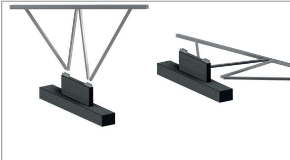
5. Das vormontierte „Gestell“ mittels geeignetem Hubgerät aufstellen und in die Fundamentschuhe einfädeln.
