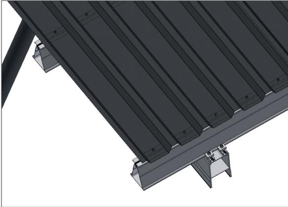
Trapezbleche auf die Pfetten auflegen, nach Zeichnungsvorgaben ausrichten und mittels Bohrschrauben und Akkuschrauber befestigen.
