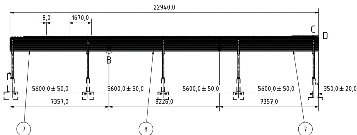
Die Neigung nach allen Richtungen und die Verdrehung der Betonfundamente sollen ±1 % nicht überschreiten -> Spannungen -> Materialermüdung
