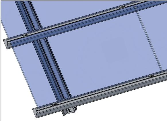
Der Abstand der Modulklemme und somit des Solarmoduls vom Rand ist der Übersichtzeichnung zu entnehmen. Auch die Klemmpunkte des Solarmoduls sind darauf maßlich eingetragen.
