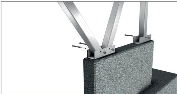
6. Die Rohre (Streben) mit Schrauben und Muttern mit den Fundamentschuhen verbinden. Die Muttern sind dabei wieder Handfest anzuziehen.
