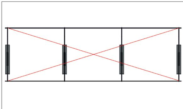
10. Für eine exakte Ausrichtung ist es auch notwendig die Diagonalmäße der beiden Modultragprofile zu überprüfen (diese müssen identisch sein), und ggfs. neu auszurichten. (+/- 5 mm)
