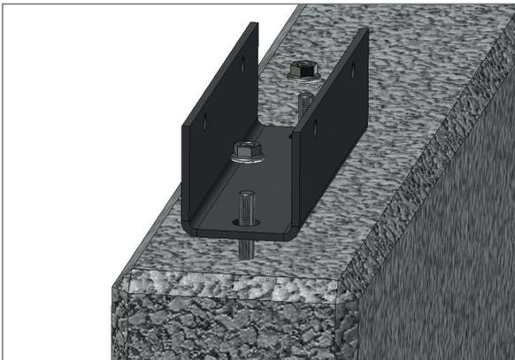
1. Fundamentschuhe auf die Gewindebolzen der Betonfundamente aufsetzen, mittels Richtlatte und Schnur horizontal und diagonal ausrichten und die Muttern festziehen.
