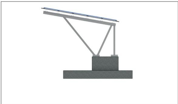
7. Beim positiven oder negativen Carport: Das senkrechte Rohr mittels Wasserwaage senkrecht ausrichten.
