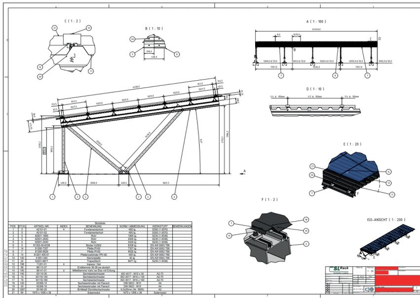
Ein Carport-System wird auf der Baustelle aus unterschiedlichen Komponenten zu „Tischen“ aufgebaut. Ein Tisch besteht im Lieferzustand i.d.R. aus folgenden Baugruppen:
