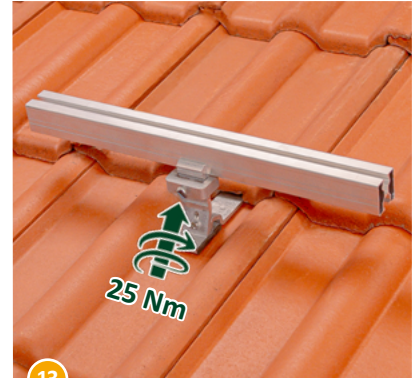
13 Die Klemmkombination mittels Schraube (25 Nm \pm 0,5 Nm) festziehen – fertig!
