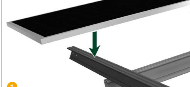
1 Solarmodul auf Z-Pfette auflegen.
