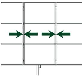
Die genannten „Anzeichen für Erosion“ können die Standfestigkeit der Anlage gefährden. Ein weiteres Anzeichen dafür, dass die Tischkonstruktion Erosion oder mechanischen Fehlern (wie z.B. lose Schrauben) ausgesetzt ist, ist eine augenscheinliche Veränderung des Modulabstandes. Dieser ist bei der jährlichen Wartung stichprobenartig (2 % der Anlage) zu überprüfen.
