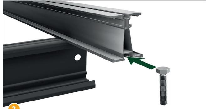
**2** Schraube von Stahlsparrenklemme (Artikel-Nr. 41502-00) im unteren Kanal des Sparren einhängen und bis zum Anschlag des Sparrenträgers schieben.
