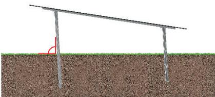
**Hangabwärts geneigte Pfosten:** Starke Hangneigungen und eine geringe Erosionsresistenz des Untergrundes können dazu führen, dass sich die Pfosten hangabwärts neigen.
