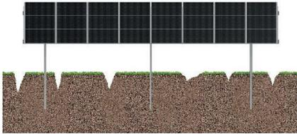
**Erosionsrinnen:** Furchen, die durch fließendes Wasser entstehen. Der Abtrag von Bodenteilchen kann im schlimmsten Fall die Standfestigkeit der Anlage gefährden.
