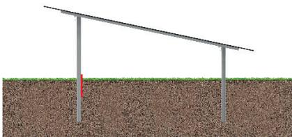
**Spaltmaß Boden-Rammfundament:** Ein Hohlraum zwischen Rammfundament und Boden kann ebenso durch Austrocknung des Bodens, sowie Abtrag von Bodenteilchen durch Wind (Deflation) entstehen. Das Spaltmaß sollte nicht mehr als 5 cm betragen.
