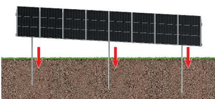
**Setzungen am Tisch:** Setzungen kommen i.d.R. bei frisch aufgefüllten, nicht verdichteten Böden vor, die durch die Auflast allmählich kompaktiert werden.
