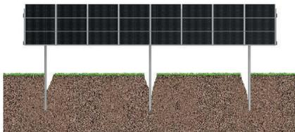
**Freigespülte Pfosten:** Von fließendem Wasser freigelegte Rammprofile
