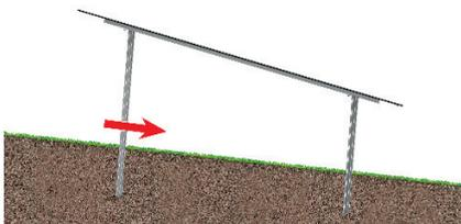
**Abweichungen der Tischneigung im flachen Gelände:** Durch Wasser/Schnee oder starke Winde verursachte Tischneigung im flachen Gelände.
