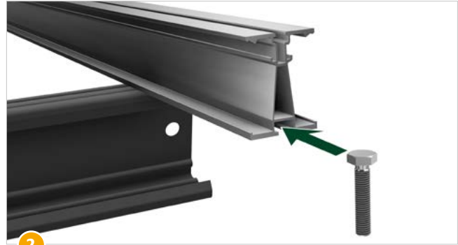
2 Schraube von Stahlsparrenklemme (Artikel-Nr. 41502-00) im unteren Kanal des Sparren eingehängen und bis zum Anschlag des Sparrenträgers schieben.
