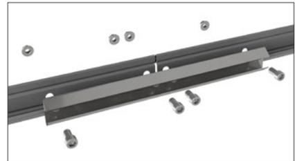
*Verbindung zweier Stahlpfetten mittels
