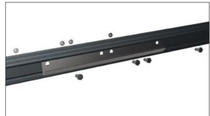
*Verbindung zweier Stahlpfetten mittels
