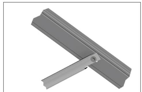
*Strebe zur Verbindung von Rammprofil und Binder*
