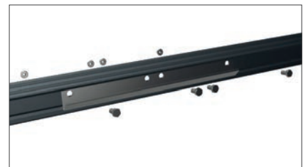
Verbindung zweier Stahlpfetten mittels Sechskantschrauben
