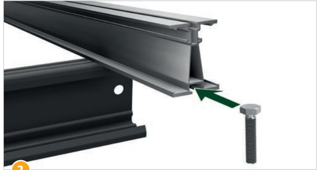
2 Schraube von Stahlsparrenklemme (Artikel-Nr. 41502-00) im unteren Kanal des Sparren einhängen und bis zum Anschlag des Sparrenträgers schieben.
