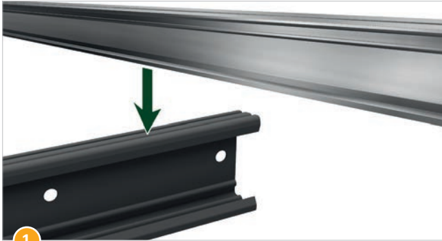
1 Sparren auf dem Sparrenträger platzieren.
