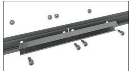
*Verbindung zweier Stahlpfetten mittels
