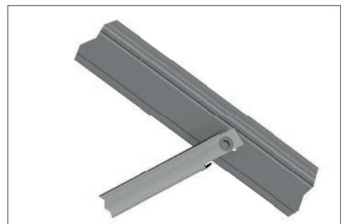
*Strebe zur Verbindung von Rammprofil und Binder*
