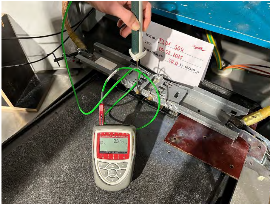
Bild 14: Temperaturmessung am Prüfmuster – Bohrschraube 2.
