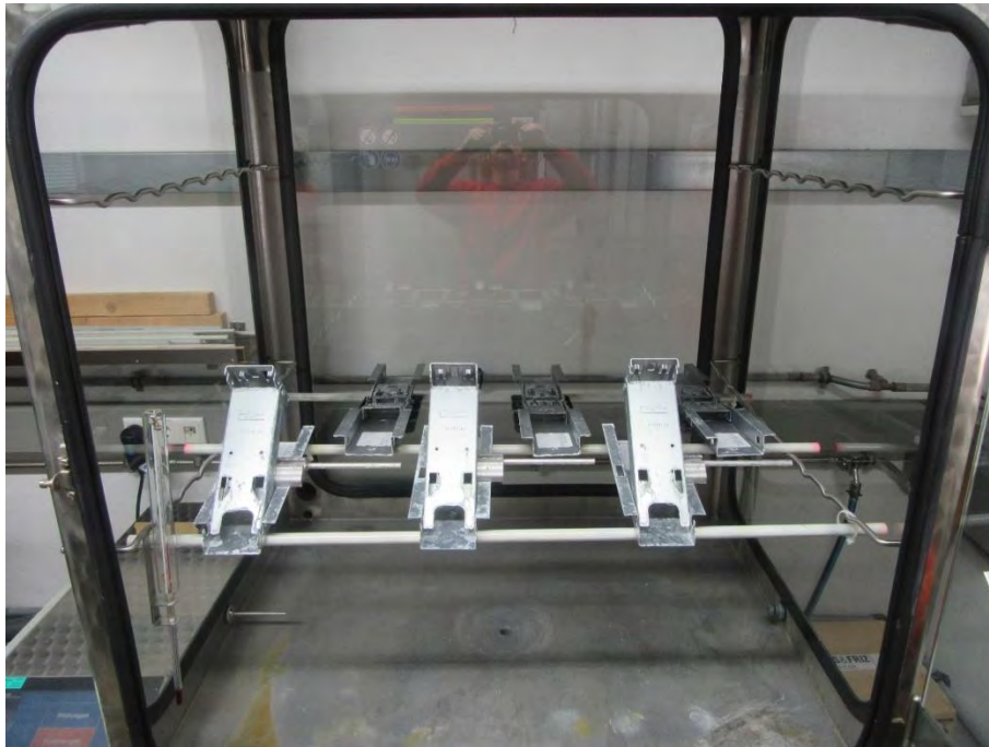
Bild 4: Prüfmuster im Gerät für feuchte schwefelige Atmosphäre.
