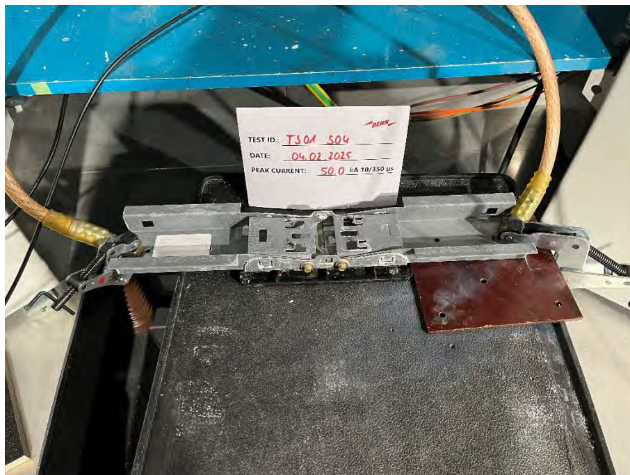
Bild 7: Prüfmuster TS01 S04 vor der Belastung mit 3x 50 kA (10/350 µs).
