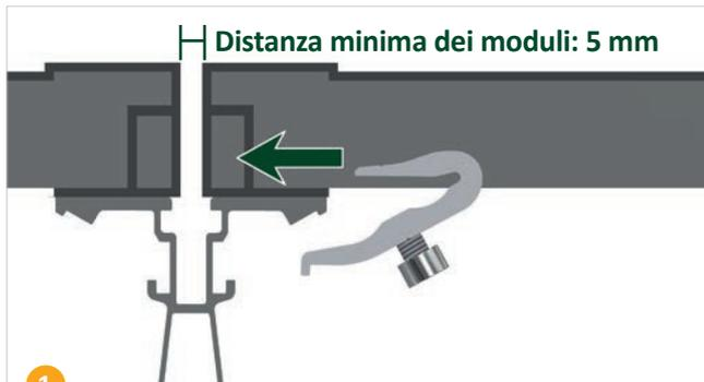
Fare scivolare il morsetto sul telaio del modulo.
